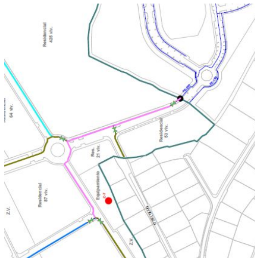
PUNTO DE CONEXIÓN RED DE GAS
