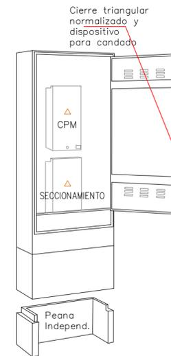
**CAJA DE CONEXIONADO PARA PUNTOS DE LUZ**
