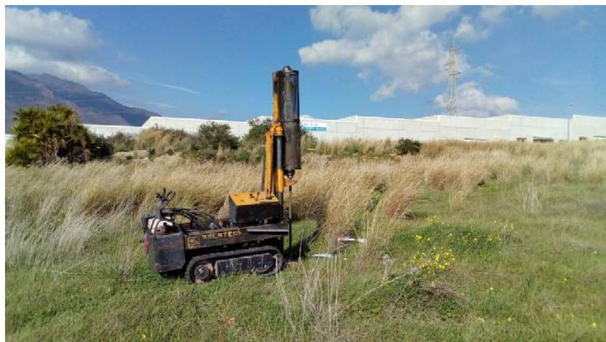
Figura Nº 27.- Emplazamiento del ensayo de penetración dinámica P-04.
