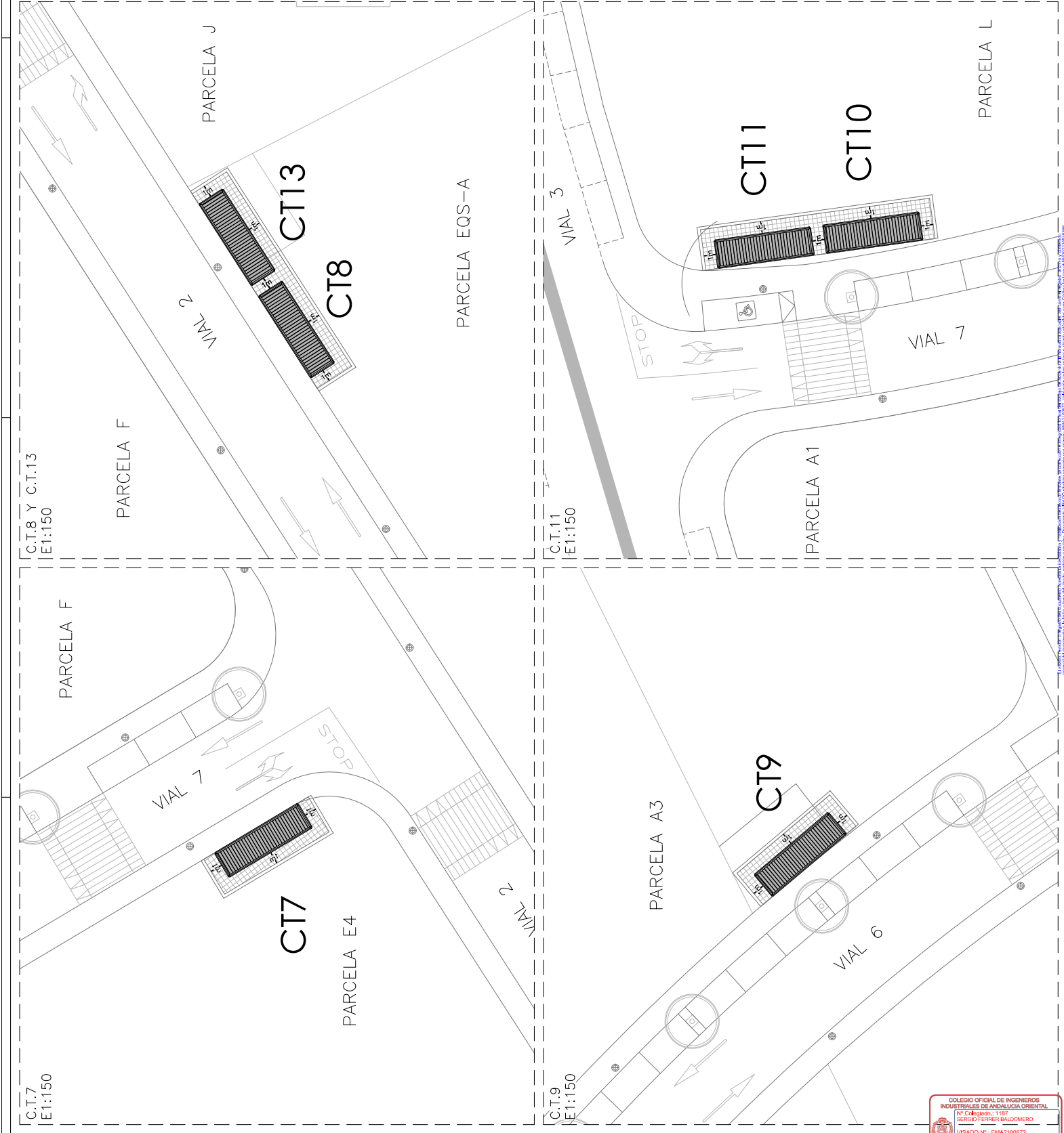
CENTRO DE TRANSFORMACIÓN PREFABRICADO TIPO GRUABAL PFI-7 DE 2 TRANSFORMADORES 630KVA - 24KV E1:100
